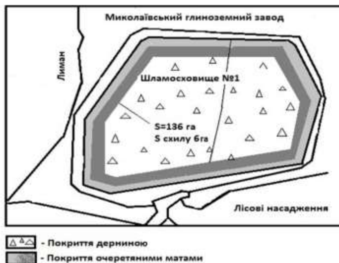
Рис 2. Схематичний приклад покриття для поверхні шламосховища №1 МГЗ
