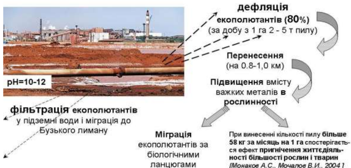
Рис 1. Схема перенесення екополютантів хвостосховищ у докiллi (на прикладi Миколаївського глиноземного заводу)
