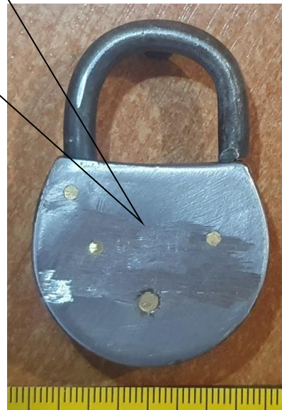
Зображення 4, 5. Ділянка передбачена для нанесення заводського маркувального позначення на задній кришці корпусу, наданого навісного замку
