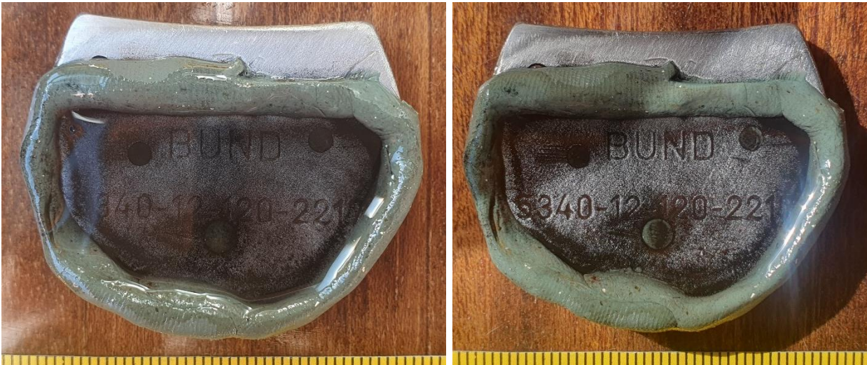
Зображення 6, 7. Осадження магнітних часток суспензії на різному проміжку часу
