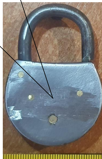
Зображення 8, 9. Відновлені маркувальні позначення на поверхні корпусу навісного замку, наданого на дослідження
