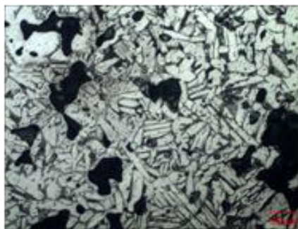
Рис. 1 – Мікроструктура титану губчастого, легованого Al та V, \times 500
