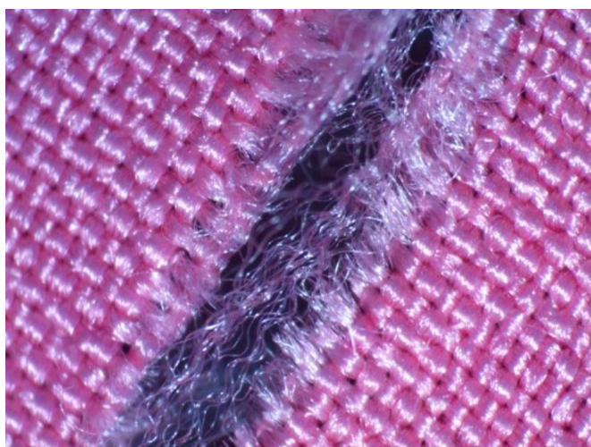
Рис. 3. Збільшене зображення пошкодження на тканині з креповим способом переплетення ниток (30-х збільшення)
