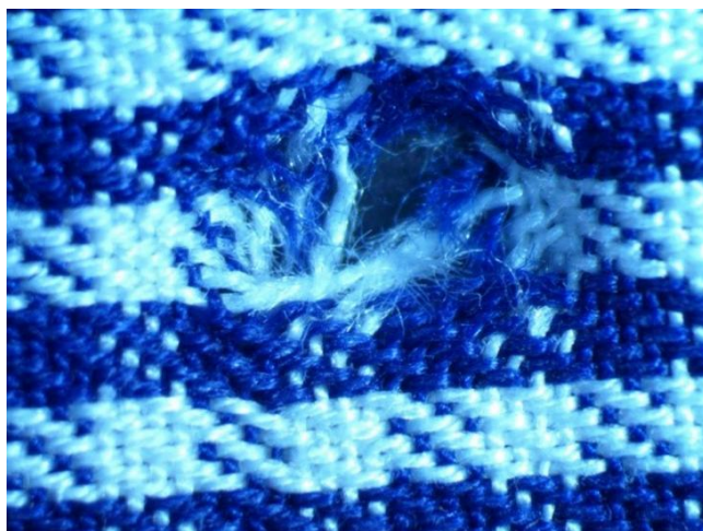
Рис. 10. Збільшене зображення пошкодження на тканині з саржовим способом переплетення ниток (30-х збільшення)
