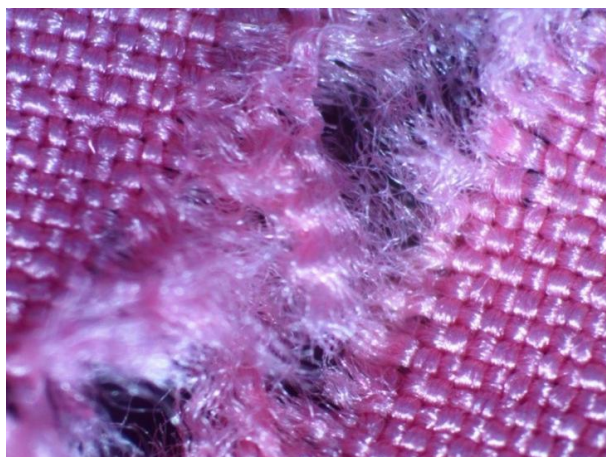
Рис. 6. Збільшене зображення пошкодження на тканині з креповим способом переплетення ниток (30-х збільшення)
