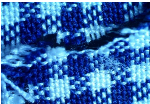
Рис. 5. Збільшене зображення пошкодження на тканині з саржовим способом переплетення ниток (30-х збільшення)
