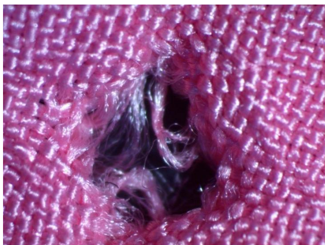
Рис. 11. Збільшене зображення пошкодження на тканині з креповим способом переплетення ниток (30-х збільшення)
