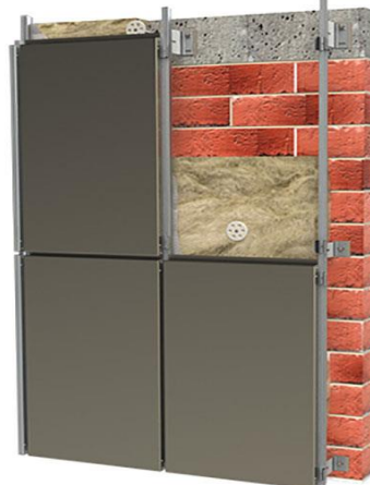
Рис 1. Навісний вентильований фасад
